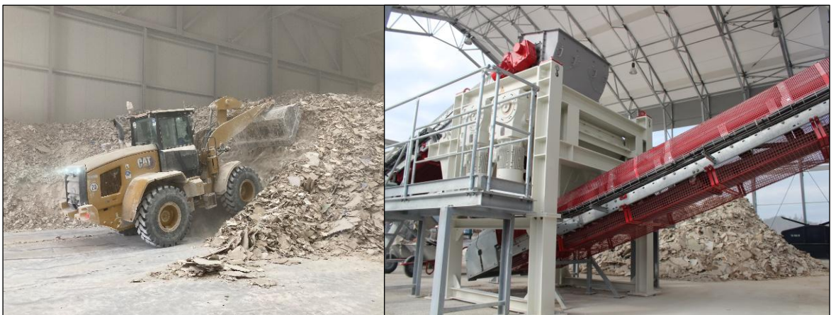
Abbildung 41: Beispielhafte Darstellung einer Gipsaufbereitungsanlage, Recycling von Gipsplattenabfällen [BV Gips 2024]
